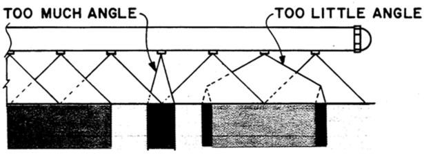
STREAKING DUE TO IMPROPER NOZZLE ANGLES
