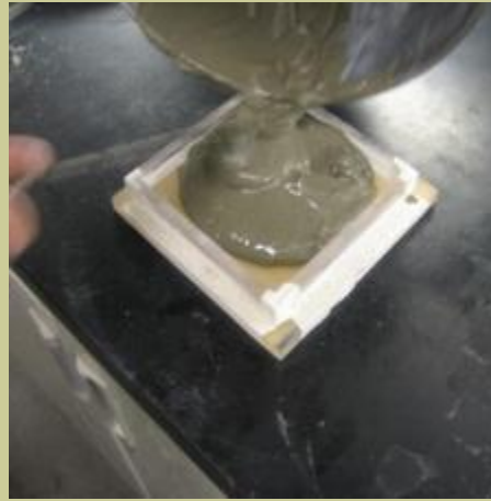
Pouring cement paste
